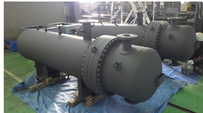
温水発生器 最高使用圧力4Mpa φ700×2,140L (主用材: 胴SB410, コイルSTB340-SC)
