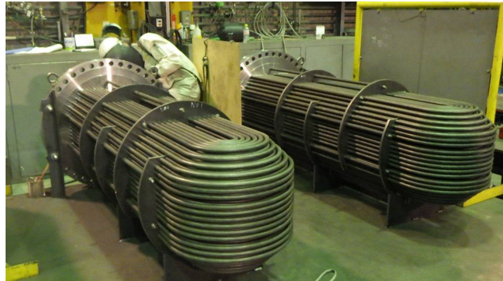
温水発生器 最高使用圧力4Mpa φ700×2,140L (主用材: 胴SB410, コイルSTB340-SC)
