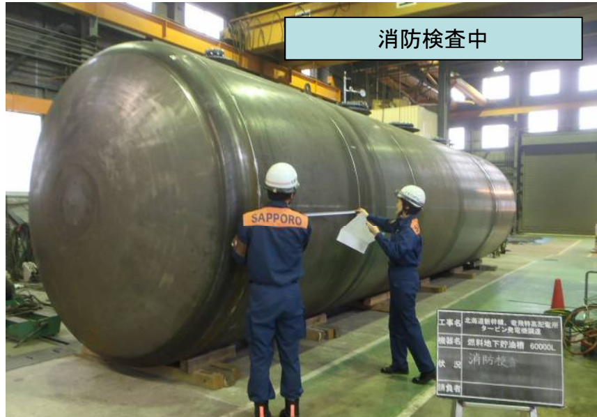
SF2重殻60KLオイルタンクを 製作させていただきました Φ2,800 * 11,200 SS400 t=9 下の写真は同時期に製作させていただいたSFタンク1,9KL
