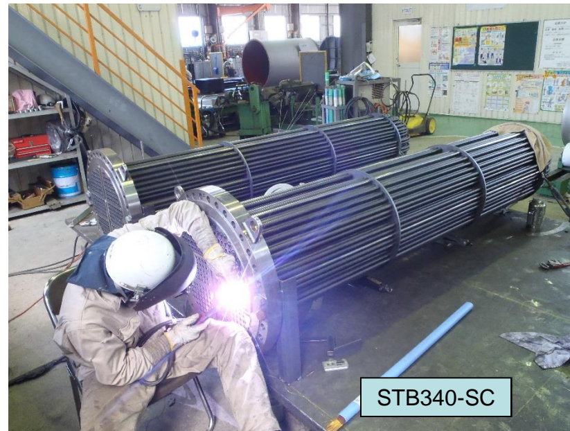
蒸気発生器 本体 950 × 550 × 全長3,650L
