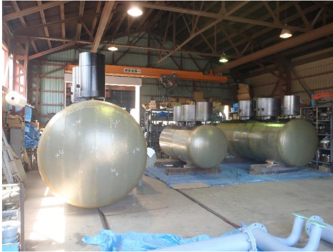
左から 8KL・4KL・7KL SFタンク
