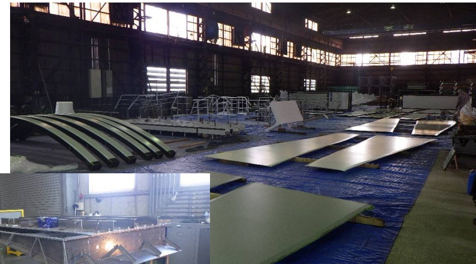
バンカ側板SS6t/4.5t 組立後最終 φ12,000×18,950H
