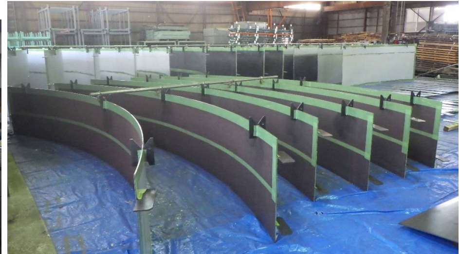
バンカ側板SS6t/4.5t 組立後最終 φ12,000×18,950H
