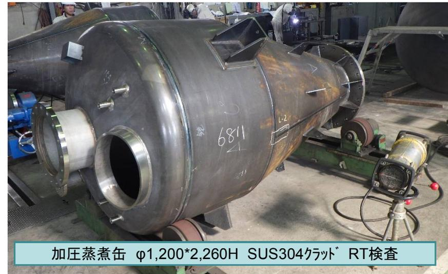
加圧蒸煮缶 φ1,200\*2,260H SUS304クワッド RT検査
