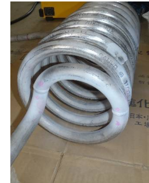
溶接箇所 PT・RT検査
