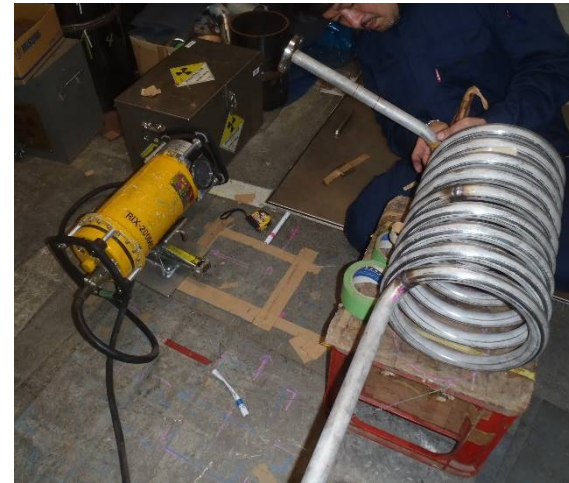
油用クーラーコイル 2つ 製作させて頂きました SUS304L-TPS sch80
