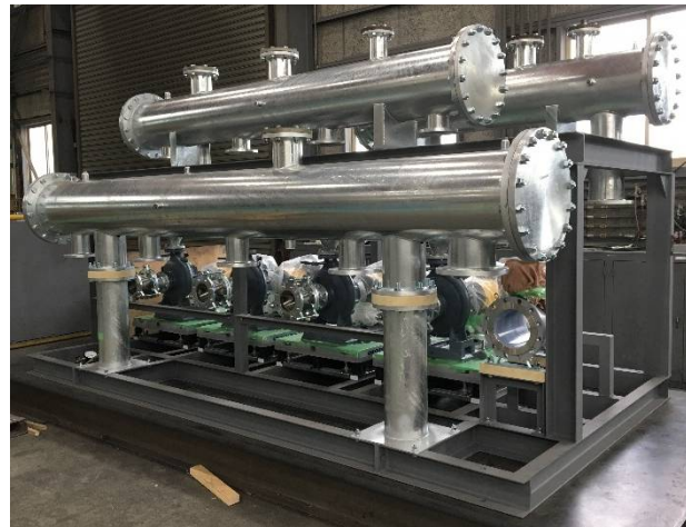
レシーバータンク(2圧) 設計製作させて頂きました
