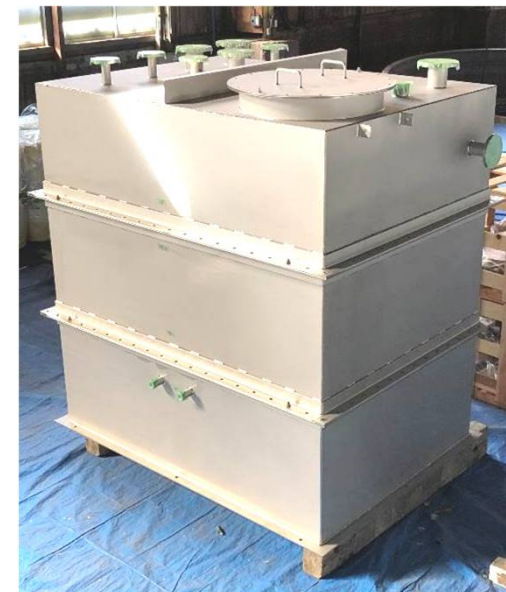
現場組 還水槽
