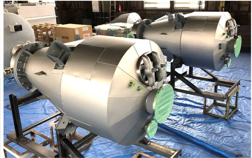
生産能力増強に伴い加圧蒸煮缶 2缶製作させて頂きました
