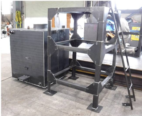
オイルサービスタンク
