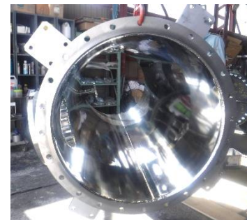
タンク内面仕上げ
