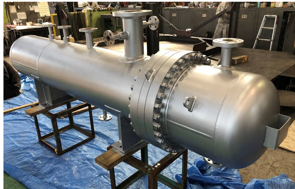
温水発生器 第1種圧力容器 設計製作させて頂きました 胴 SB410 伝熱管 STB-340S 最高使用圧力 1次側 4.0Mpa
