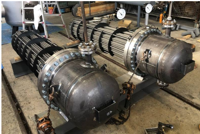
温水発生器 第1種圧力容器 設計製作させて頂きました 胴 SB410 伝熱管 STB-340S 最高使用圧力 1次側 4.0Mpa
