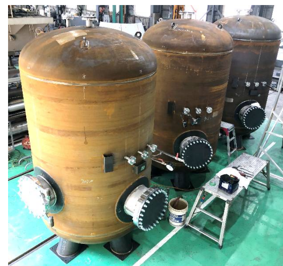
ストレージタンク \phi 1,600 \times 2,000H 設計製作させていただきました 350Kw Pmax=4Mpa クラッド鋼板仕様 第1種圧力容器
