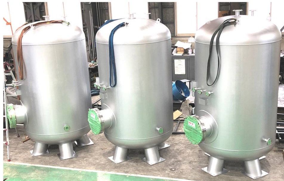
ストレージタンク \phi 1,600 \times 2,000H 設計製作させていただきました 350Kw Pmax=4Mpa クラッド鋼板仕様 第1種圧力容器
