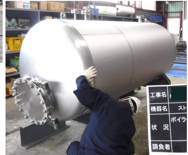
ボイラー協会による1圧検査
