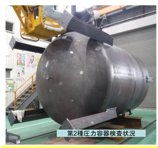
窒素レシーハ つタンク 設計・製作 Φ2,300\*H2,540 t=12、14 最高使用圧力0.9mpa
