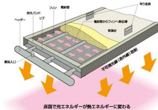
床面で光エネルギーが熱エネルギーに変わる
