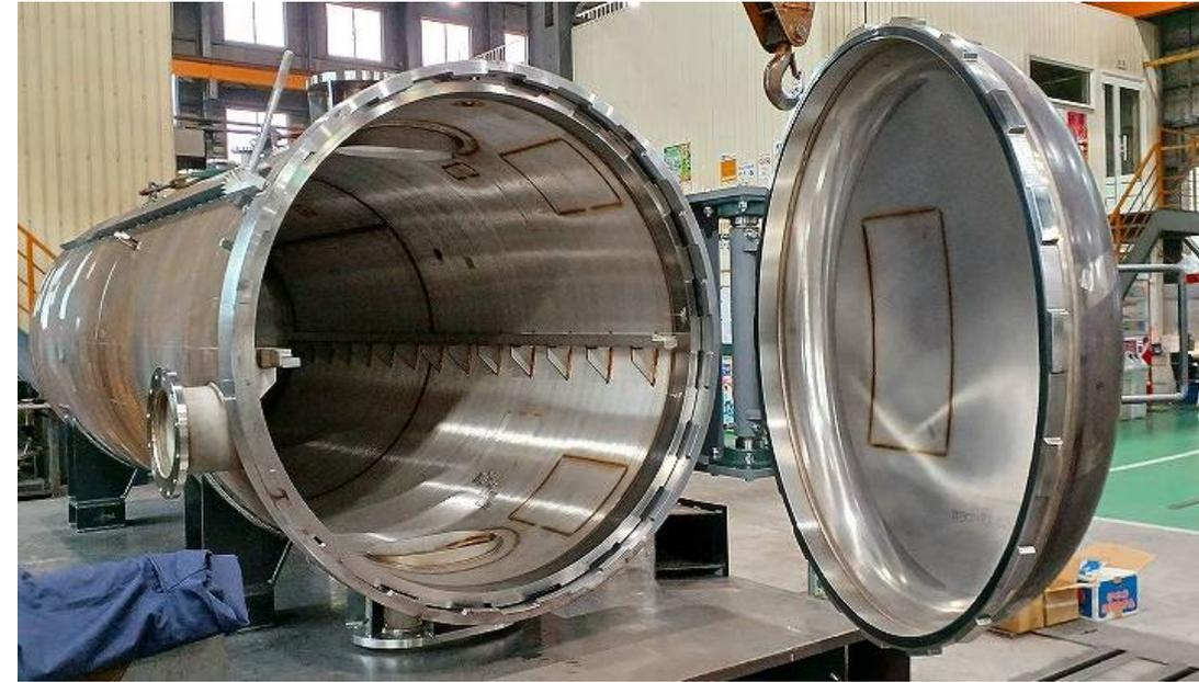
横型加圧蒸煮缶(第1種圧力容器) 設計製作させて頂きました
