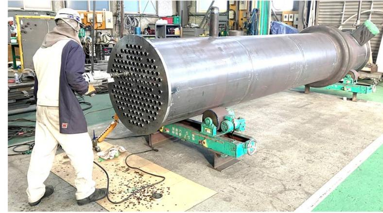
※近畿地区向けの硫酸熱交換器を製作させて頂きました(上部写真)
